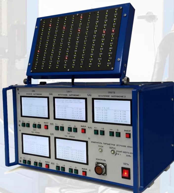
ИПО-1, созданный для устранения «узкого места» (*bottleneck*) на операции измерения параметров оптронов, производимых АО «Оптрон», в полной мере с незначительными доработками можно применять для измерения значений характеристик диодов, транзисторов, стабилитронов и других полупроводниковых приборов, в т.ч. и в бескорпусном исполнении.
